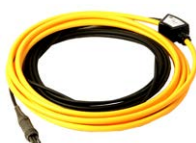
Cęgi elastyczne FS-2 (Ø 1260 mm), poziom wyjścia 100 mV / 1 A
